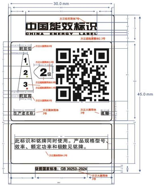
图 2 异步起动三相永磁同步电动机能效标识样式示例（简易）
